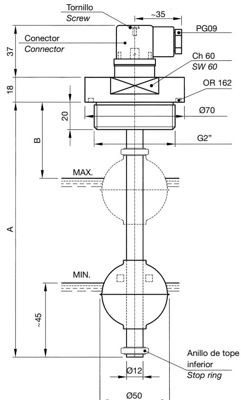
MATERIALES: brida rosada, tubo, anillos de parada y flotador en acero inoxidable.
