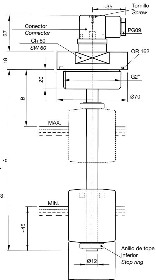
MATERIALES: brida de aluminio anodizado, tubo de latón, anillos de parada en bronce, flotando en resina expandida NBR.
